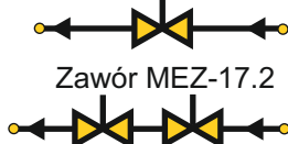
Układy połączeń Zawór MEZ-17
